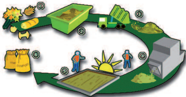
Principe du compostage industriel sur plateforme
